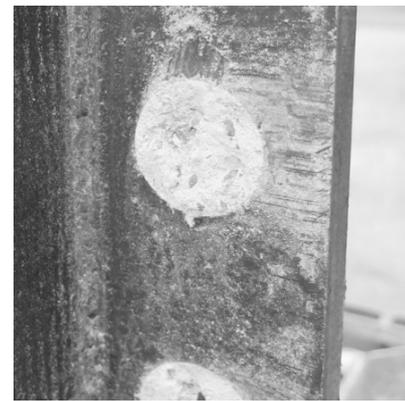
図4 試験後の孔あき鋼板ジベル (PS-3)
