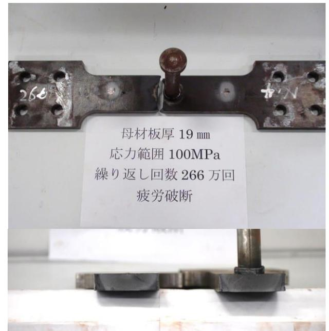
写真-4 破断状況 ( $100\text{N}/\text{mm}^2$ )
