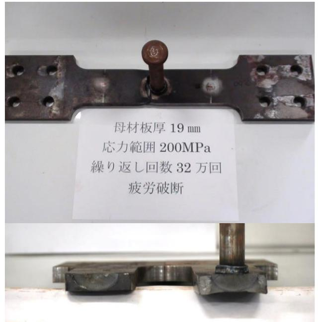
写真-3 破断状況 ( $200\text{N}/\text{mm}^2$ )
