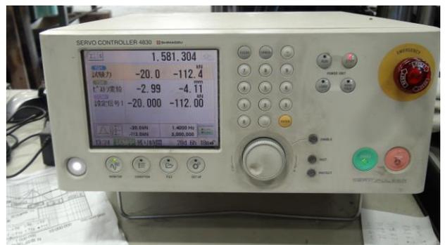
写真-2 島津サーボパルサ 4830 型制御装置
