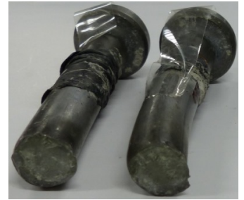
写真-2 押抜き標準試験時のスタッドのせん断破壊面
