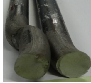
写真-1 試験体 L4.5S のせん断破壊面
