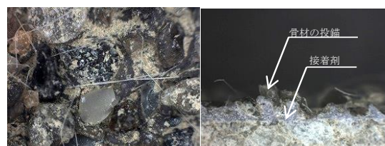
AD-1 打継ぎ界面の状況(接着剤使用)
