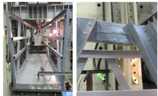
(a) 上弦材の横倒れ座屈 (b) 上弦材のせん断破壊
