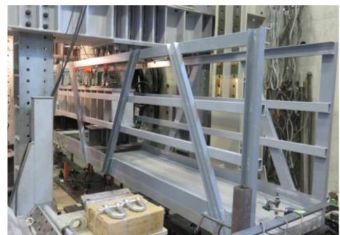
図-4 載荷実験のセットアップ状況(3パネルモデル)
