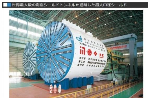
図-3 事例2: シールド機械 (提供: 三菱重工)
