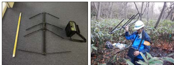
写真-2 左: 八木アンテナ、右: 調査実施状況
