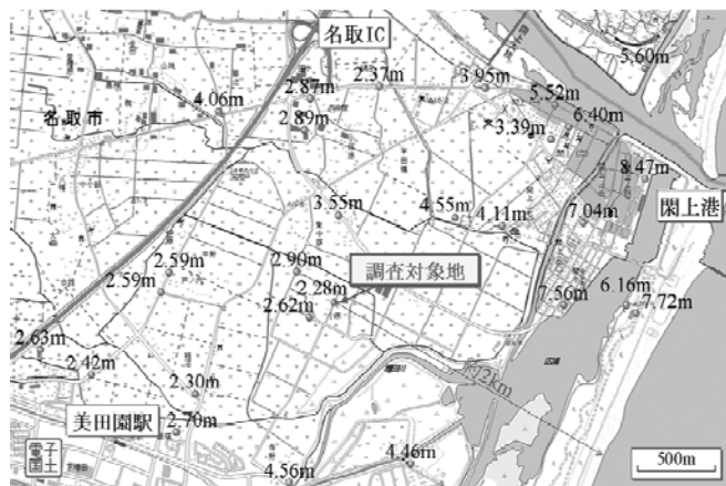
図1 調査地周辺の津波浸水高
