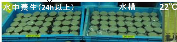
写真-1 乾湿繰り返し試験状況
