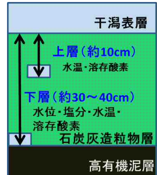
図-2 水質計設置・測定概要
