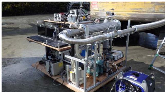
図-1 排出ガス測定装置設置状況
