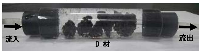
写真1 D材を封入した流水条件でのカラムテスト
