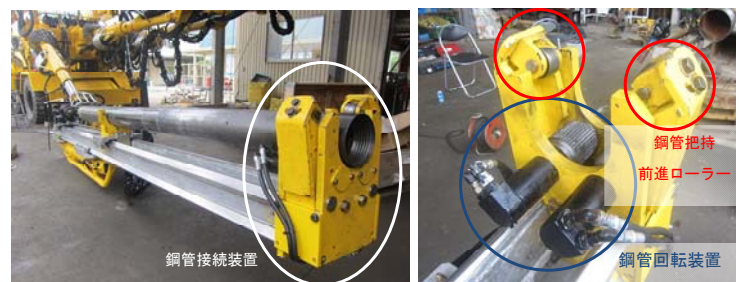
写真－4 鋼管継装置
