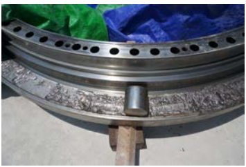
写真-3 リーニングレースウェイ損傷
