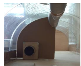
写真-1 遮蔽体を設置したトンネル模型
