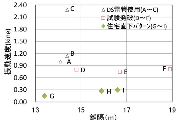
図 6 発破位置からの距離と振動速度の関係
