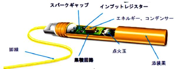
図1 高精度電子雷管の構造概要(eDev II)
