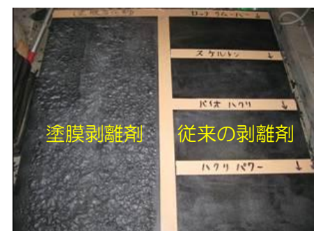
図4 剥離剤による剥離状況の比較
