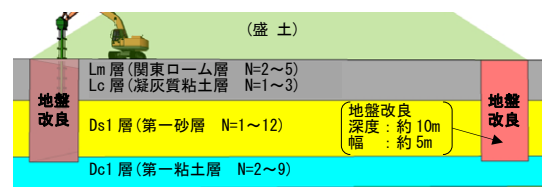
図-1 地盤改良概略図
