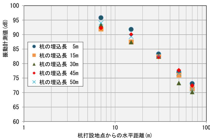
図-3 杭打設時の振動値 (杭の埋込長別の整理)
