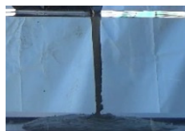
写真1 No.2の水中落下状況
