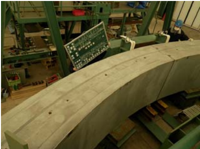
写真-2 継手曲げ試験状況
