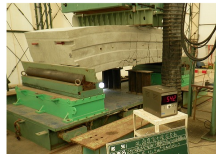
写真-1 単体曲げ試験状況
