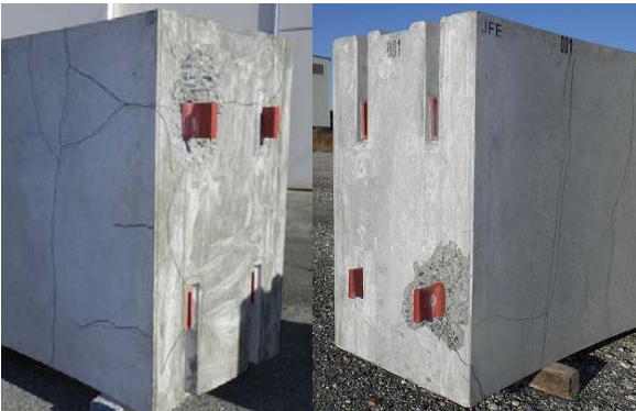
写真-3 継手部ひび割れ状況
