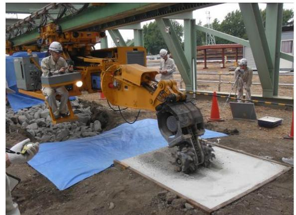
写真-1 油圧式切削機による模擬地盤切削状況
