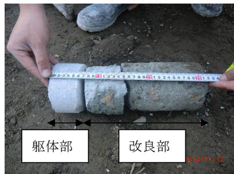
写真-3 削孔試験後のコア採取状況
