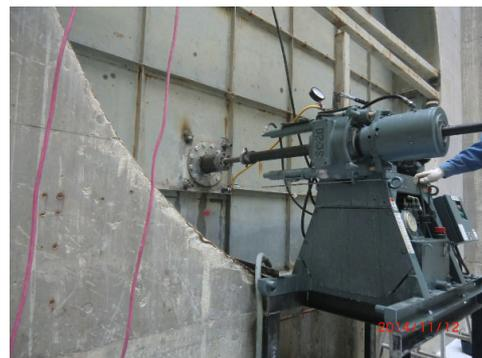
写真-2 削孔試験装置
