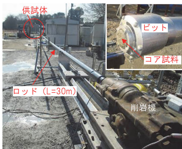
写真－1 コア採取実験状況
