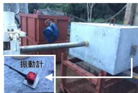
写真-2 供試体削孔状況
