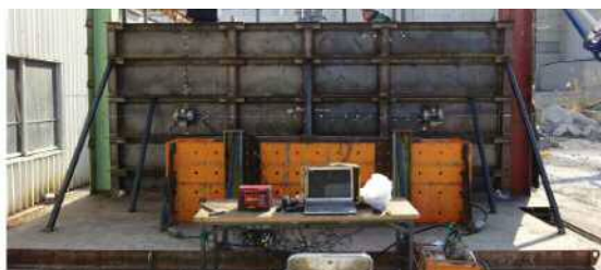
写真-1 大型型枠全景 (5000×2000×300(mm))
