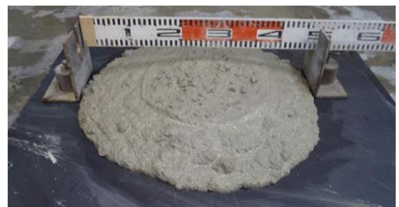
写真-1 凝結促進剤を添加した中流動覆工コンクリート
