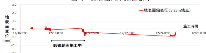
図-6 地表面(③)変位状況
