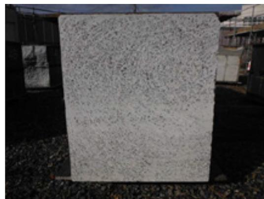
図-4 切断面(流動距離50m)
