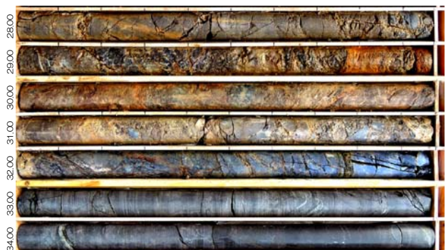
図-2(a) ボーリングコア (孔内傾斜計 K3-1)
