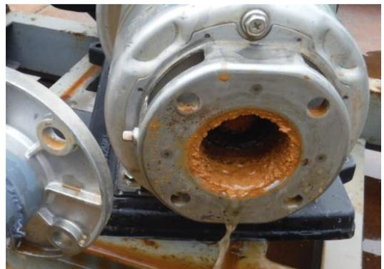
図-4 注水ポンプ内写真(稼動36日後)
