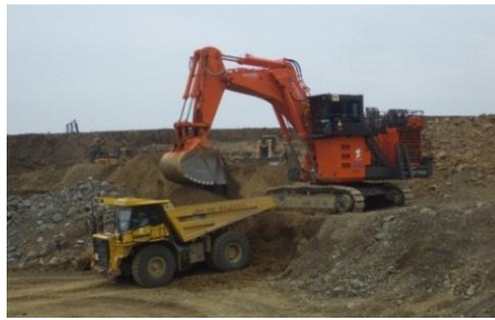
写真－2 超大型建設機械による積み込み (55t ダンプトラックと12 \text{m}^3 油圧ショベル)
