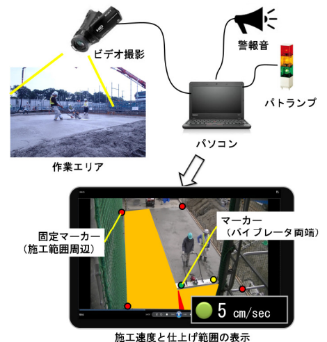
図2 施工管理システムの構成
