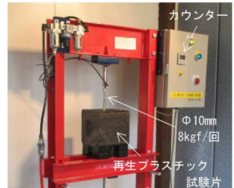
写真-2 載荷試験機
