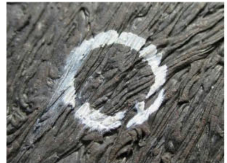
写真-3 試験後の供試体 (繰り返し載荷 一万回後)
