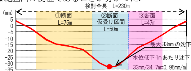
図-5 鉄道函体縦断方向変位分布
