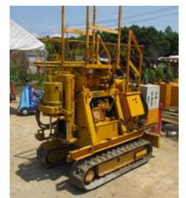
写真-3 予定機械 (自走式ボーリングマシン)
