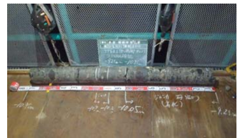
写真-7 注入改良後 コンクリートコア
