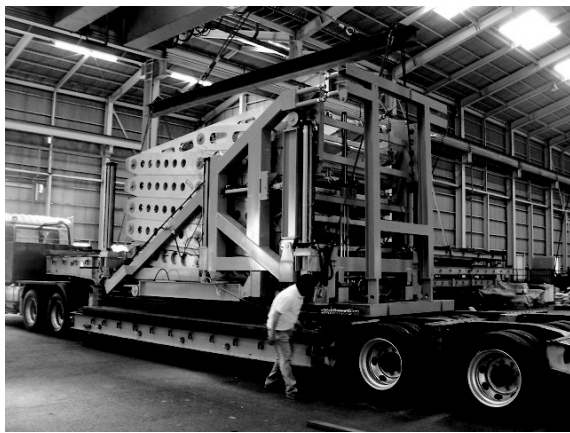
写真-2 折り畳める可搬展開橋「モバイルブリッジ (MB)」
