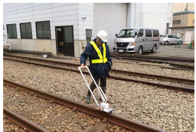
図-3 ジャイロセンサ装置を用いた軌道計測状況
