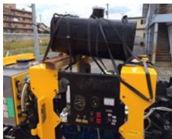
図 6 燃料タンク傾斜
