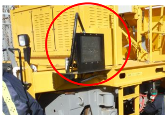
図 4 オイルクーラー設置
