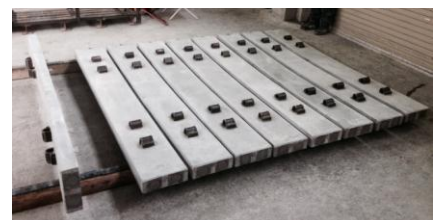
写真1 試作した薄型まくらぎ(H=70mm)
