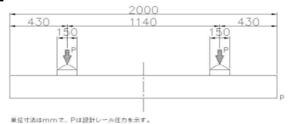
図1 応答値算出道床反力モデル
