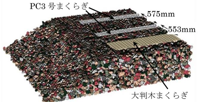
図1 離散体バラスト軌道レール継目部モデル
