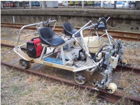
写真－1 塗油装置
