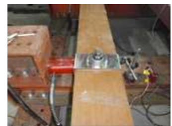
(b) まくらぎ移動抵抗試験状況
