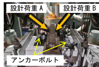
図4 载荷試験の状況
