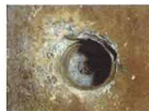
改削孔径 \phi 37\text{mm}
