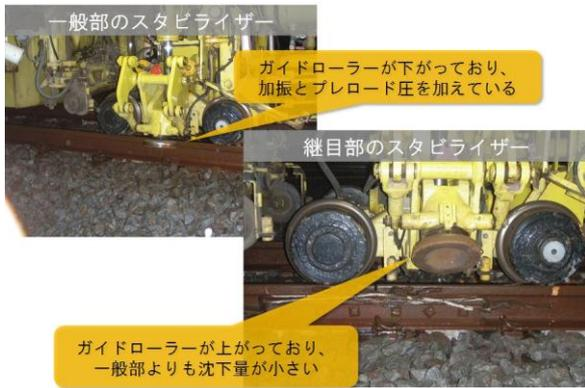
図-3 一般部と継目部のスタビライザーの例
