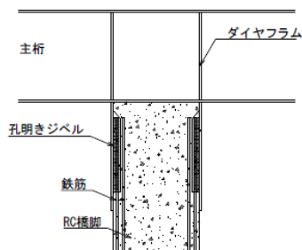
図-3 接合部の構造
