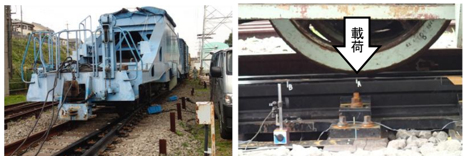
(a) 移動式軌道動的載荷試験装置 (b) 載荷状況
