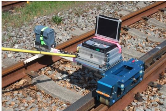
図1 レール凹凸連続測定装置の外観
